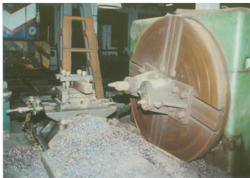
Zdj.4,5 Stan zachowania tokarki przed rozpoczęciem prac – fot. historyczna
